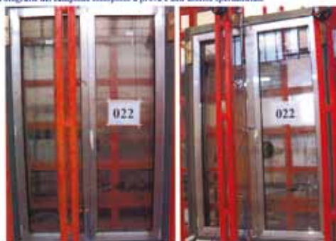
Foto 1 e 2: Campione sottoposto a prova nell'assetto sperimentale e durante i test di resistenza al carico del vento (prova di deformazione a pressioni positive e negative)
