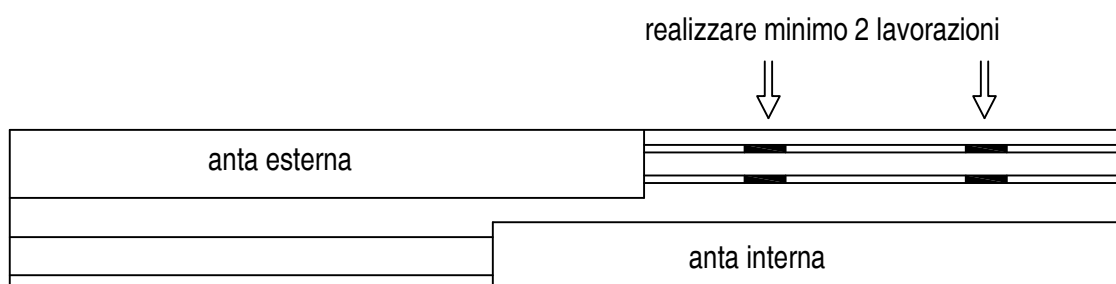
pianta della finestra con indicato dove realizzare le lavorazioni
