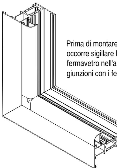
Prima di montare l'angolino occorre sigillare la sede del fermavetro nell'angolo e le giunzioni con i fermavetri
